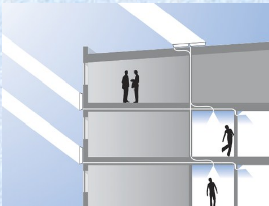
Рис. 1.39 Проект дома в Шанхае (КНР) с системой отражателей, которые направляют солнечные лучи к световой трубе и атриуму. Архитектор Кауфман и др. (за [95])
